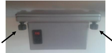
2) Lösen Sie die 2 Schrauben des Reaktorträgers, so kann dieses entnommen werden.
